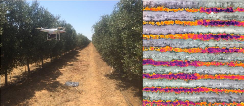
Dron con cámara de infrarrojos para la evaluación del estado hídrico de un un olivar en seto de alta densidad (izqda.). El plástico negro en el suelo actúa de superficie de referencia para la temperatura. Fotografía tomada por el dron a 20 m de altura, con una resolución de 5 cm (dcha.; cortesía de los Drs. G. Egea y M. Pérez-Ruiz). La presencia del color rojo en parte de las filas de árboles denota un estrés hídrico excesivo ocasionado por una reducción drástica del riego.
