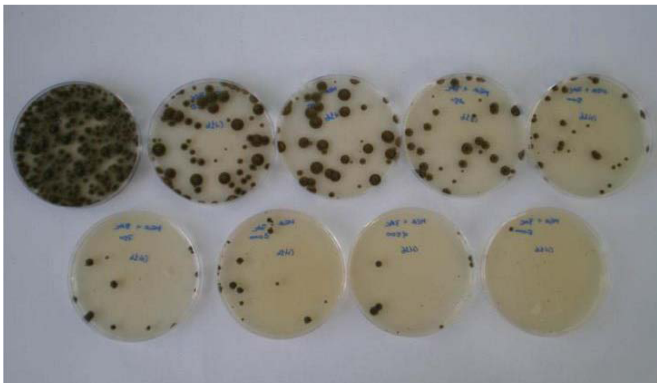
Crecimiento en distintas concentraciones de cloruro de benzalconio de Ochroconis lascauxensis , aislado de la cueva de Lascaux. De izquierda a derecha: 0, 50, 100, 250, 500, 750, 1.000, 2.500 y 5.000 mg/l. Fuente: Tesis doctoral de Pedro M. Martín Sánchez: Las manchas negras de la cueva de Lascaux. IRNAS, 2012. Cesáreo Sáiz Jiménez.
